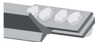
Unión entre baterías modulares
